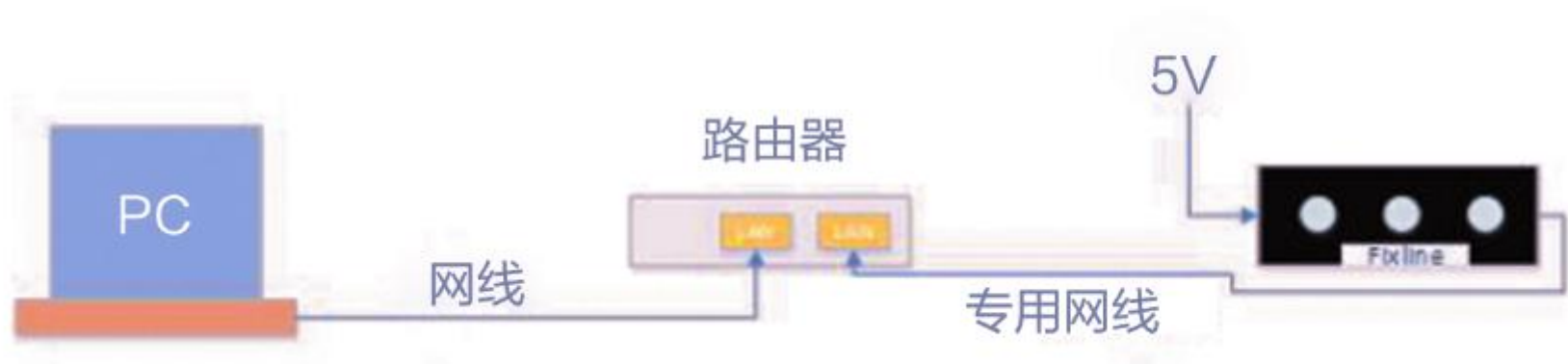
图 20.激光轮廓仪与路由器连接
